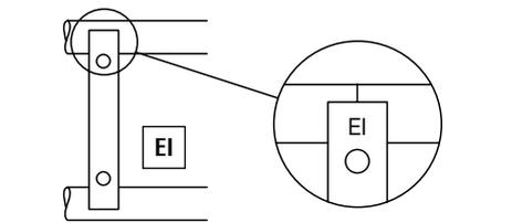
À noter que leur longueur est calculée de façon à ne pas gêner le roulement des galets du côté extérieur de la barre.
