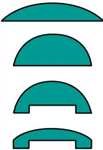
AA en arc allongé pour angles d'enroulement faibles. Sur ce type, le patin est amovible et encastré dans un profilé métallique analogue à celui des glissières " NO FRIX ".
